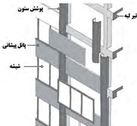
شکل ۸-۶- انواع دیوار پرده ای شیشه-آلومینیوم
