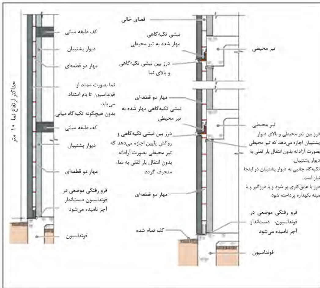
شکل ۵-۹- تکیه‌گاه‌ها جهت تحمل بار ثقلی نما
