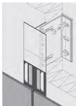
شکل ۷-۳۹- سیستم نصب پنهان با چسب صنعتی
