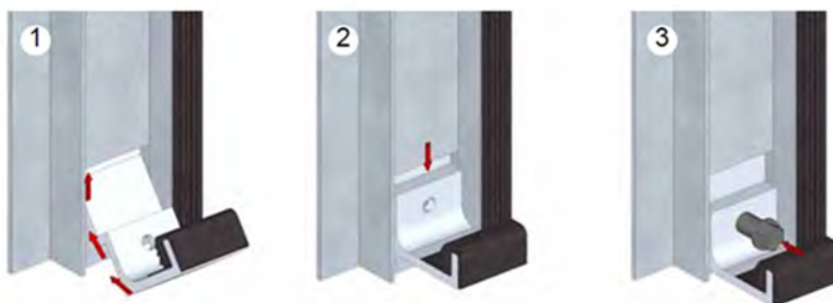
شکل ۷-۱۲- نحوه نصب بستها بر روی ریل
